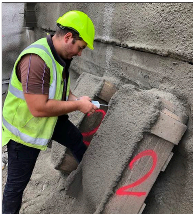
18. ábra: Penetráció mérés a lövőládán
